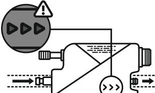
**6** Соедините насосный модуль и датчик трубкой 6x9 мм и укрепите соединения хомутами-стяжками. Длина трубы должна быть не более 1.5 м.
