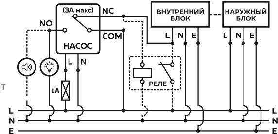
**10 ПРОВЕРКА.** Постепенно наполняя водой поддон испарителя кондиционера дождитесь включения и последующего выключения насоса. Повторите испытание, увеличив скорость наполнения. Убедитесь в корректном отрабатывании аварийной ситуации – отключении установки при достижении водой аварийного уровня. Убедитесь в отсутствии протечек в дренажной системе.
