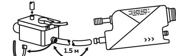
**7** Подсоедините к насосу выпускную трубку 6x9 мм, затянув соединение хомутом-стяжкой. Проверьте, чтобы на всем протяжении трубы не было заломов и других препятствий для свободного отвода конденсата.
