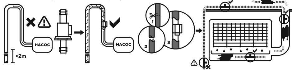
**9** Подключите насос к сети электропитания. Для того, чтобы предотвратить ущерб из-за протечек в случае выхода дренажного насоса из строя, настоятельно рекомендуется подключить аварийную опцию (ALARM). Коммутационная способность контактов аварийной схемы ЗА-/~240В. Если в вашем случае этого недостаточно, используйте дополнительное реле (см. схему.)
