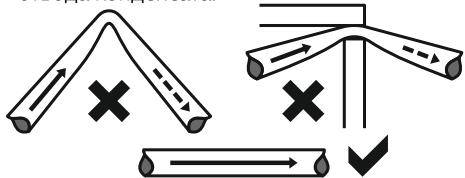
**8** Конец выпускной трубы рекомендуется не опускать ниже 2 метров относительно насосного модуля. В противном случае будет наблюдаться «сифонный эффект» и для его подавления будет необходимо установить антисифонный клапан в одном из допустимых мест (см. рисунок).
