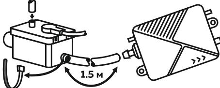
**7** Подсоедините к насосу выпускную трубку 6x9 мм, затянув соединение хомутом-стяжкой. Проверьте, чтобы на всем протяжении трубы не было заломов и других препятствий для свободного отвода конденсата.
