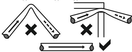
**8** Конец выпускной трубы рекомендуется не опускать ниже 2 метров относительно насосного модуля. В противном случае будет наблюдаться «сифонный эффект» и для его подавления будет необходимо установить антисифонный клапан в одном из допустимых мест. (см. рисунок)
