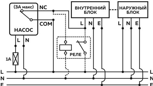
**10 ПРОВЕРКА.** Постепенно наполняя водой поддон испарителя кондиционера дождитесь включения и последующего выключения насоса. Повторите испытание, увеличив скорость наполнения. Убедитесь в корректном отрабатывании аварийной ситуации – отключении установки при достижении водой аварийного уровня. Удовстверьтесь в отсутствии протечек в дренажной системе.
