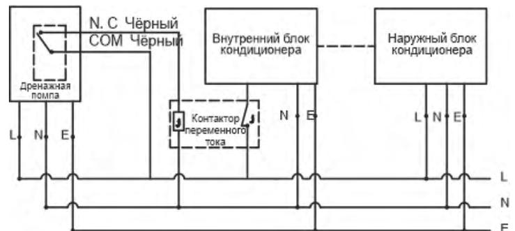
Если в кондиционере отсутствует контроллер уровня жидкости, то аварийную линию можно подключить к контактору переменного тока, для контроля питания кондиционера.
