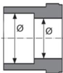
Рис. 9: ступенчатый внутренний диаметр
