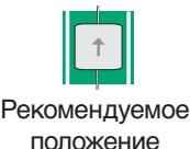
Вертикальное нагнетание гарантирует герметичность обратного клапана.
