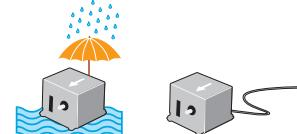
Вода может попасть в насос вследствие конденсации на трубке или нарушения герметичности соединения прозрачная трубка/наконечник насоса
